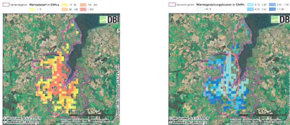
Abbildung 1: Exemplarische Ergebnisse Geoheat-N: Wärmebedarf (obertage) und Wärmegestehungskosten hochaufgelöst in Abhängigkeit des Standorts und unter Berücksichtigung der techno-ökonomischen Ergebnisse
