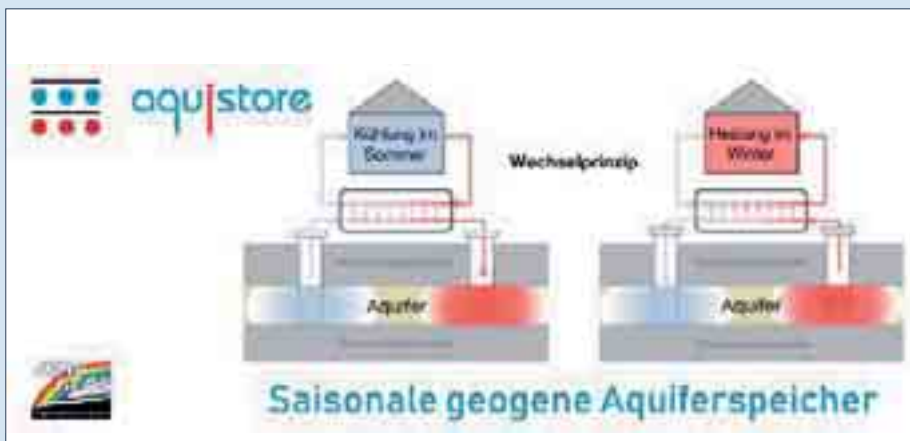
Vereinfachte Darstellung des Aquiferspeicher-Prinzips, Archiv JENA-GEOS®
