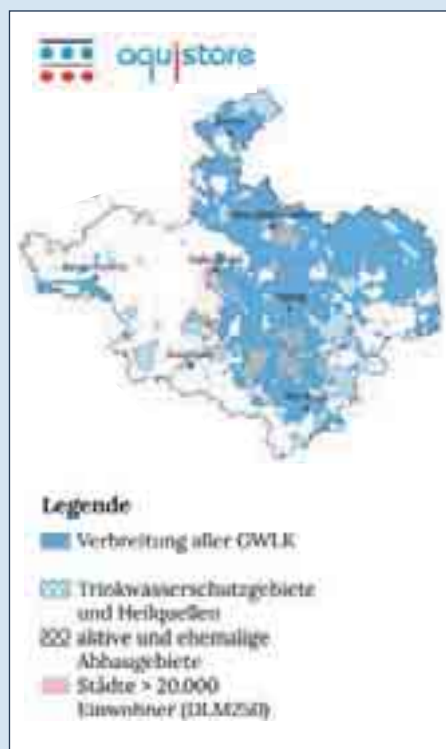
Synoptische Darstellung der Verbreitung aller für die thermische Speicherung nutzbarer Aquifere (GWLK) in der Metropolregion (JENA-GEOS®, [2])
