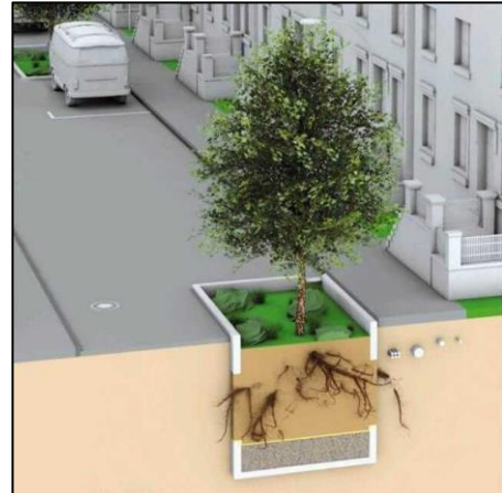
Abbildung 4: Beispieldarstellung eines Baumrigolen-Systems (Quelle: Ingenieurgesellschaft Prof. Dr. Sieker mbH o.J.)
