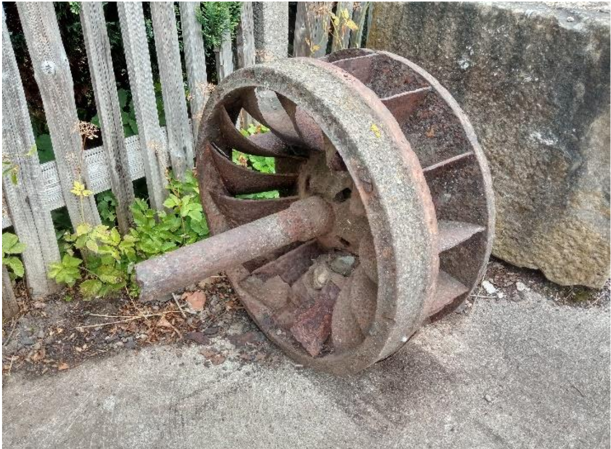
Abbildung 5: Francis-Turbine der ehem. Messerfabrik in Schweina (eigenes Foto vom 21.07.2022)
