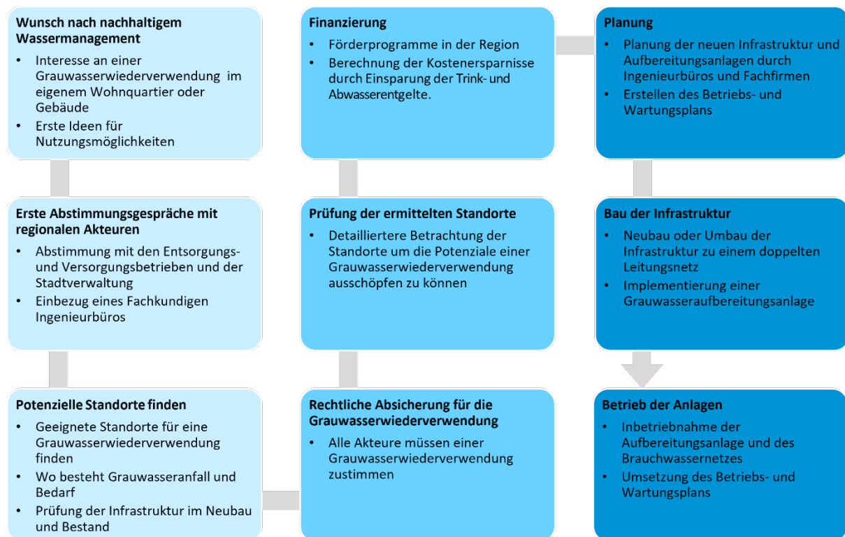
Abbildung 5: Ablaufplan vom Wunsch nach nachhaltigem Wassermanagement zum Betrieb einer Grauwasseraufbereitung
