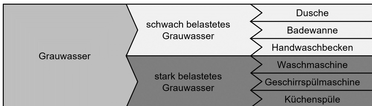
Abbildung 1: Unterteilung in schwach und stark belastetes Grauwasser (Kohlhepp, 2023 nach Sievers 2018)
